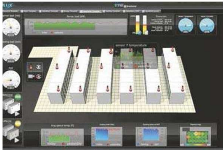
DGLux de DGLogik permet de faire du suivi des baies en température et hygrométrie avec une visualisation 3D. © Acuity Brands Inc.
